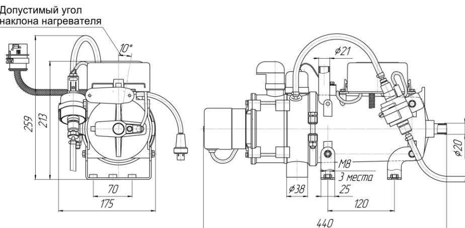
Рисунок 5- Допустимые рабочие положения нагревателя
