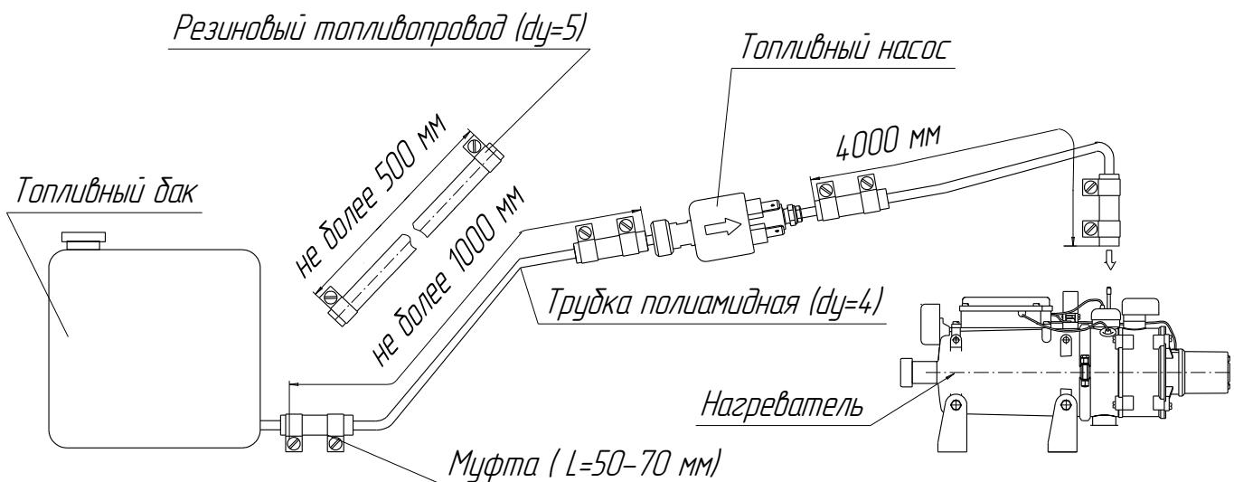
Рис. 7- Схема присоединения топливопровода к узлам подогревателя
