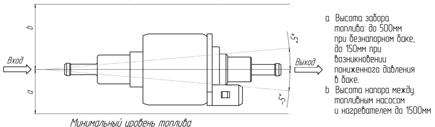
Рис. 8- Допустимое монтажное положение топливного насоса
